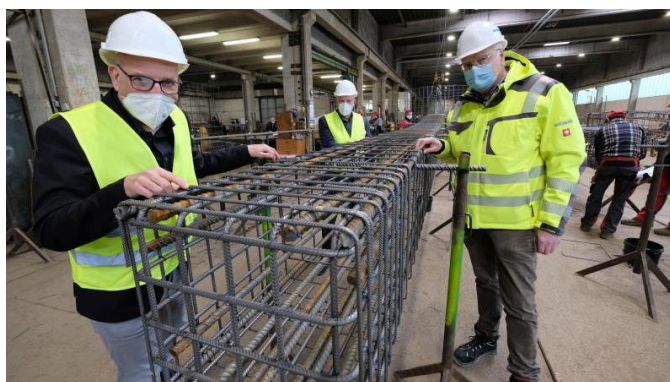
Matthias Molter (Vorstand, v. l.), Carsten Holtkamp (stellvertretender Betriebsleiter Fertigteile) und Werkleiter Helmut Kottmann stehen an einem der Bewehrungskörbe für die Stahlbetonteile.
