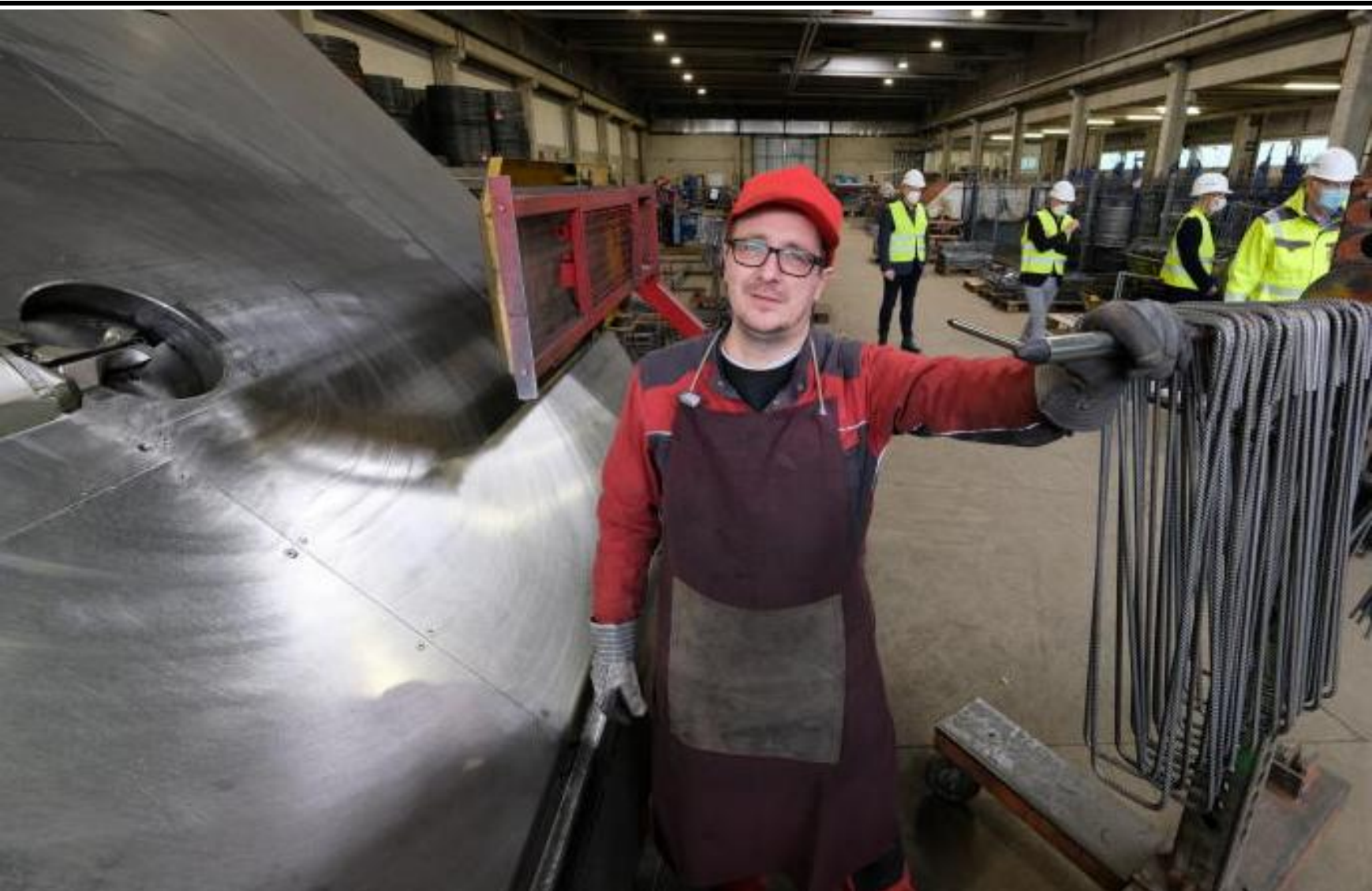
Nebi Zogaj arbeitet in der Eisenbiegerei an einer der Maschinen, mit denen die Stahlstreben für die Fertigbetonteile der Firma Bremer gebogen werden. FOTOS: HANS-HERMANN IGGES
