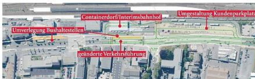
So soll der Hauptbahnhof während der Umbauarbeiten erreichbar bleiben. | © Grafik: Jürgen Schultheiß
